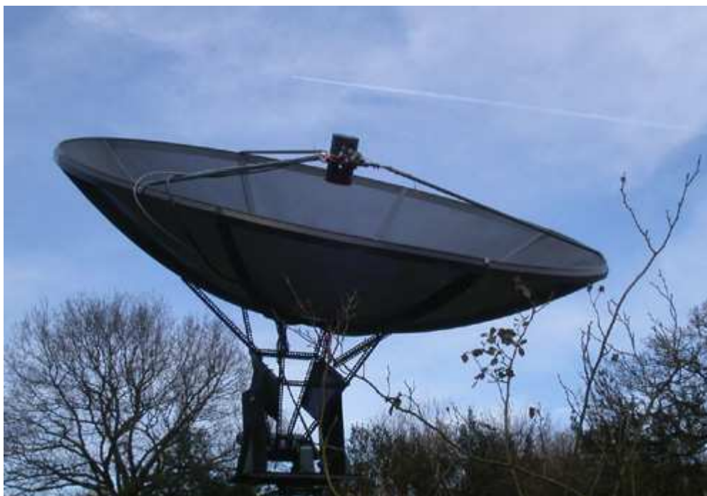
Fot. 3.11. Antena paraboliczna o średnicy 3 m na pasmo 1420 MHz
