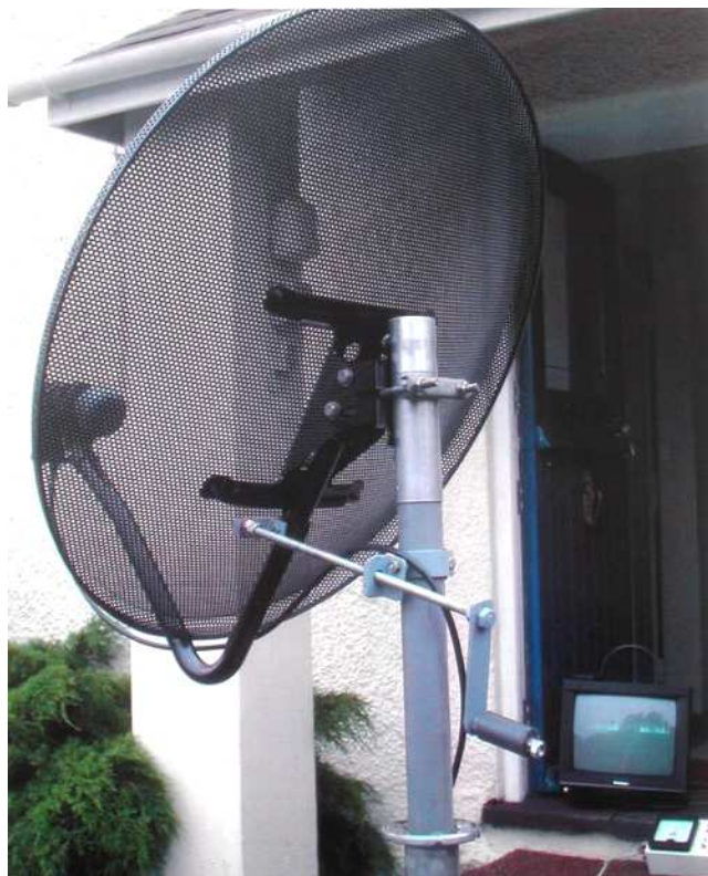
Fot. 3.12. Antena telewizji satelitarnej o średnicy 60 cm na pasmo 11 GHz.
