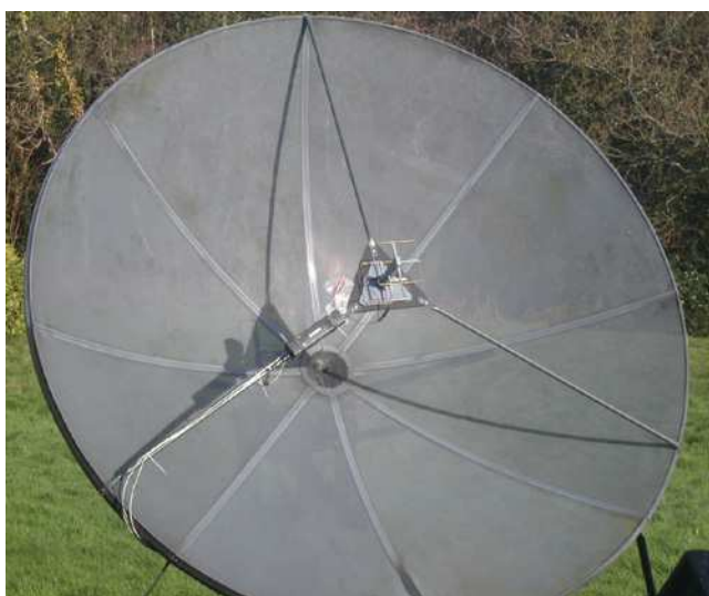
Fot. 3.8. Antena paraboliczna o średnicy 3 m na pasmo 408 MHz; f/D = 0,28 .
