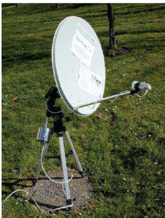
Fot. 2.15. Antena paraboliczna o średnicy 80 cm.
